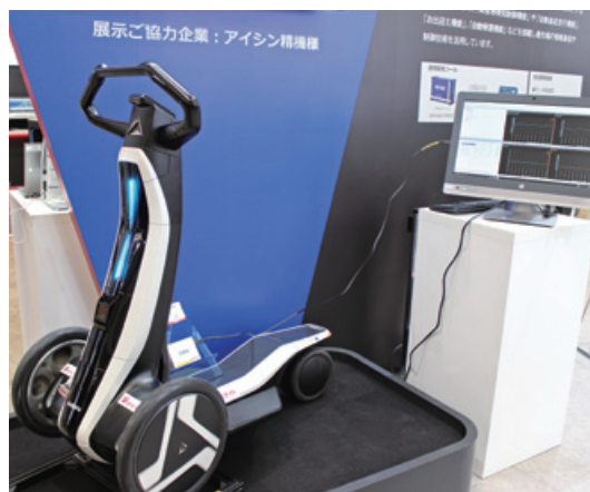
ILY-Ai(左)にEVRICAを繋ぎ行った搭載ECUの計測デモ
