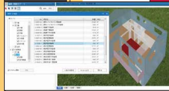
鳥瞰、俯瞰、立面、パースで表示を積算-3D確認に切り替えることで、積算数量でどの箇所が計算されているかをわかりやすく可視化します。
