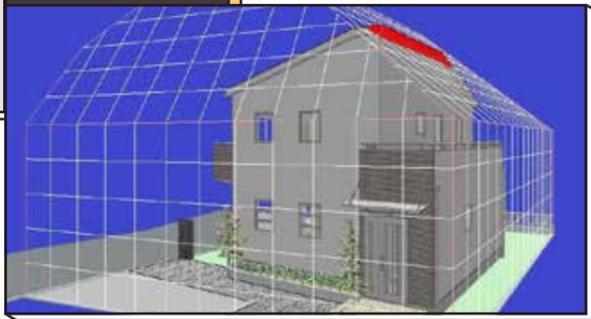
建築基準法の道路斜線、北側斜線などの高さ制限に関するチェックを行うことができます。設定された斜線条件範囲はパース上でワイヤーフレーム表示されます。また、制限外の部分は赤く表示され、一目でチェック結果がわかります。
