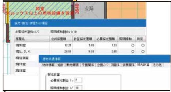
敷地境界の入力、用途地域の設定を行うことにより、建築物の確認申請レベルの採光および換気に対する建築計画のチェックを行うことができます。令和5年4月1日に施行された「照明設備の設置、有効な採光方法の確保その他これらに準ずる措置の基準等を定める件の一部を改正する告示」に対応いたしました。
