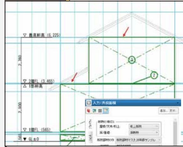
断熱仕様で桁上断熱を選択して自動生成できるようになりました。
