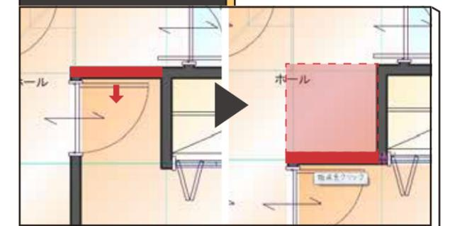
家族構成の変化などで、「部屋間の壁を取って広い部屋にしたい」などの場合には、簡単な操作で部屋を合成することができます。この操作により、関連する部屋数・寸法・面積などの情報は、積算数量に同時反映されます。
