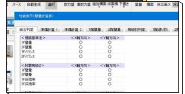
入力されたプランをもとに、伏図の有無に関わらず、木造軸組2階建て (延べ床面積 500 m<sup>2</sup>) までの住宅性能表示レベルの構造の安定に関する壁量と床倍率のチェックが行なえます。
