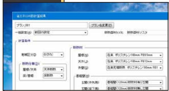
プランデータから、住宅の外皮平均熱貫流率および外皮平均日射熱取得量 (冷房期・暖房期) 計算書が作成できます。性能評価センターが提供する書式に合わせた内容で出力できます。低炭素住宅で減税措置や金利優遇を受けられるご提案をスムーズに行えます。
