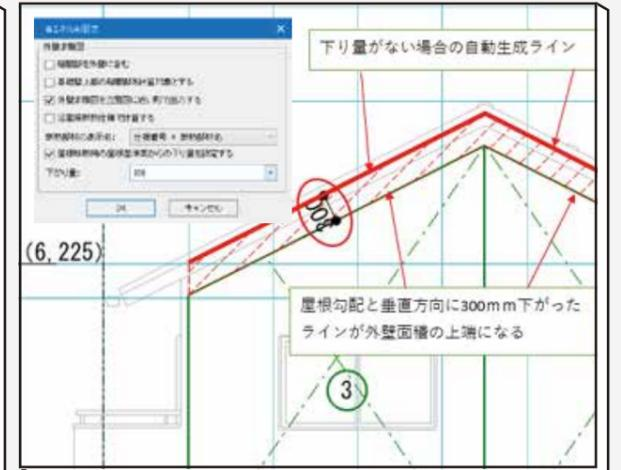
「屋根断熱」時、屋根基準高からの下がり量を設定し、外壁面積上端の高さを調整できるようになりました。
