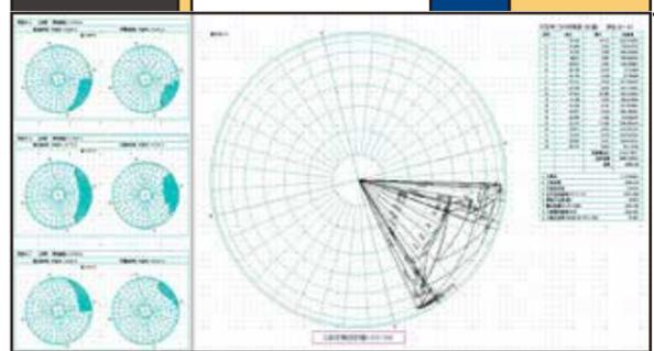
平成15年1月1日施行の改正建築基準法内において追加された天空率制度に基づき、任意の測定ポイントに対して正射影投影された図 (天空図) を出力できます。
