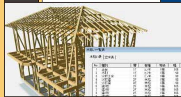
作成した伏図より、入力されている構造材の木拾いを行うことができます。土台や柱などの部位別、樹種、材寸ごとに切り回した本数や歩留まりを算出・表示する木拾い表や、部位別に木材の立米数を算出・表示する立米表を作成することができます。また、各一覧表をCSVファイルとして出力することができます。
