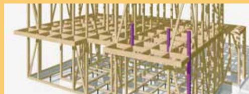
作成した伏図を、意匠同様にパースで表現することにより、目で見て構造躯体のチェックを行うことができ、ビューパネルで内部を見ることが出来ます。また、パース上で梁・柱・筋かいの変更・修正も可能で変更した材寸をリアルタイムで表示します。
