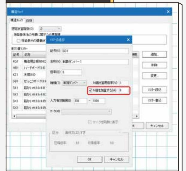
耐力壁要素の種類「制振ダンパー」に、N 値加算の値を持たせる機能を追加し、配置した制振ダンパーの両端の柱の N 値計算に反映します。算出する N 値は、制振ダンパーを考慮せず算出した N 値に N 値加算の値を単純に加算します。
