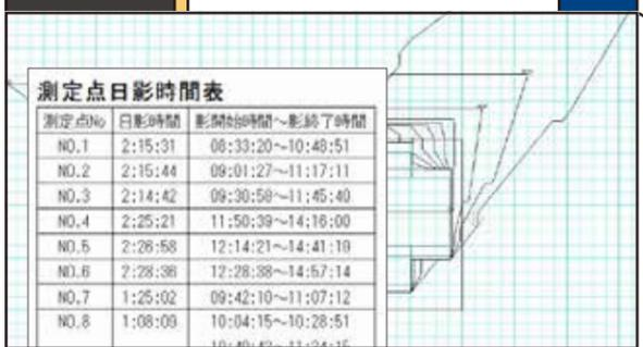
住宅地における日照を確保するため、昭和52年の建築基準法の改正により定められた「日影規制」について判定に必要な時刻日影図・等時間日影図を出力します。根拠資料として、「測定点日影時間表」を出力できるようにいたしました。
