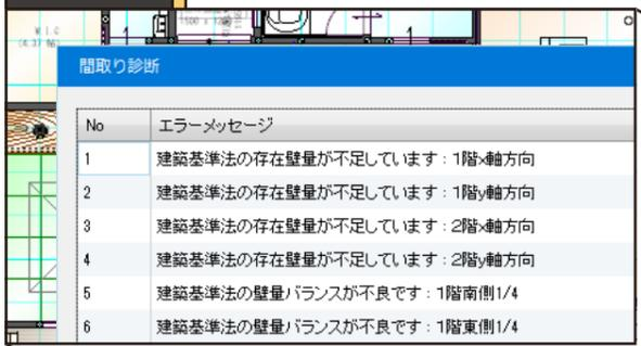
屋根を含む間取り入力 completed 段階で、性能表示に対する診断を行うことができます。構造に関する情報の入力がない状態で使用できるため、営業マンなど専門的な知識が少ない方でも、作成した間取りが構造的に実現可能かどうかをチェックすることができます。
