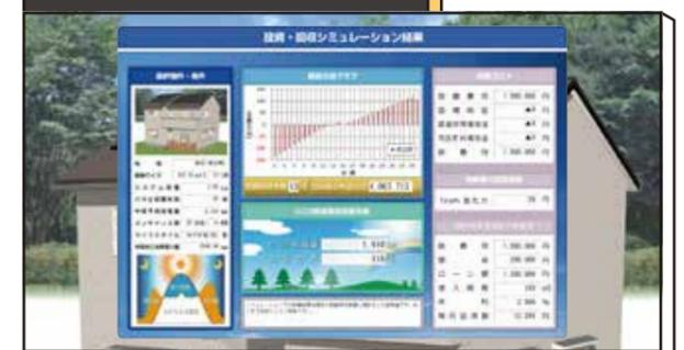
太陽光パネルをすばやく配置することができ、予測発電量・損益分岐点目安・CO<sub>2</sub>削減による環境貢献度・国、地方自治体からの補助金を交えたローンシミュレーションが行えます。また、パネル設置費用と設置費用の回収および利益額のシミュレーションにより損益分岐グラフを作成し、わかりやすくご提案できます。
