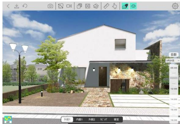
「Walk in home 360x (ウォークインホーム サンロクマルエックス)」は、「Walk in home」で作成した建物のデータをスマートフォンやタブレットで360度の角度で表示できるサービスです。モバイルデバイスを使用することで、AR機能で現地の風景と作成した物件データを合成することが可能です。また、モバイルデバイスの画面上で壁や屋根の部分透過や素材のワンタッチ変更といった編集ができます。直感的な操作で物件デザインの確認や調整が行えます。
